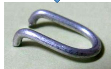
折れた部品の曲線に合わせたものを、Φ1.2の針金で作りました。先端は曲げてあります。
